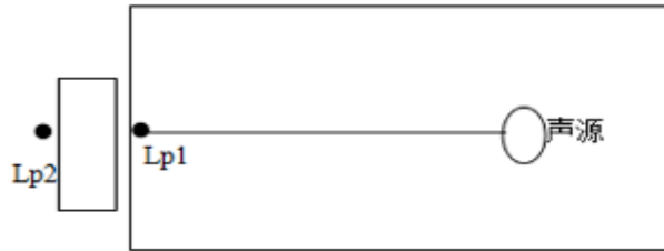
图 4-1 室内声源等效为室外声源图例
